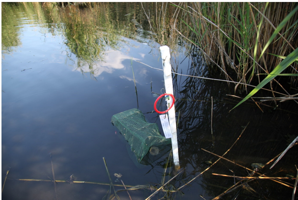
Obr. 6. Ukázka správné instalace živolovné pasti na odchyt ocasatých obojživelníků a larválních stádií žab v litorální části sledovaného vodního tělesa. Foto M. Kotasová Adámková.
